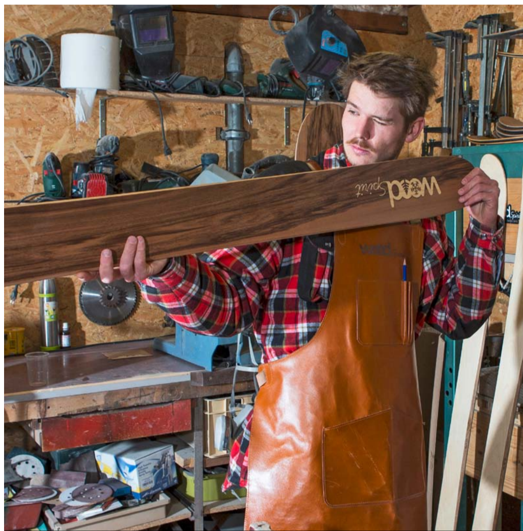
Les skis qui sortent de l'atelier de Lucas Bessard sont cousus main. Chaque paire est unique. L'artisan de L'Isle les personnalise selon les vœux du client: frêne pour la base, noyer, merisier, érable et châtaignier pour les décorations en marqueterie.
